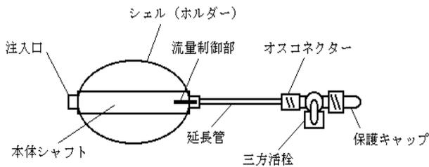
※延長管の無い製品や、流量制御部が延長管の先端に存在する製品などもある。
