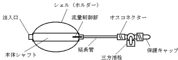
※延長管の無い製品や、流量制御部が延長管の先端に存在する製品などもある。
